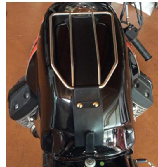
Realizzato in acciaio con cromatura ad alto spessore, viene fissato al tappo serbatoio e alla fascia in cuoio.
