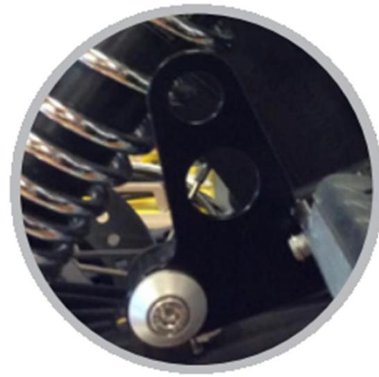
Si montano sul supporto originale e mettono in sicurezza l'appoggio pedane del passeggero
