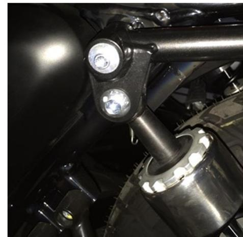
Sostituendo agli originali o montandoli sui modelli che non li hanno di serie, la moto si alza nella parte posteriore senza sostituire gli ammortizzatori
